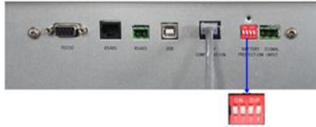
Figura 3 Configuración del No. de baterías.
